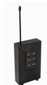
Werden mindestens 2 Strahlen (1x unten 1x oben) unterbrochen, gibt der RG ein Signal via Funk an die Zentrale "HQ"
